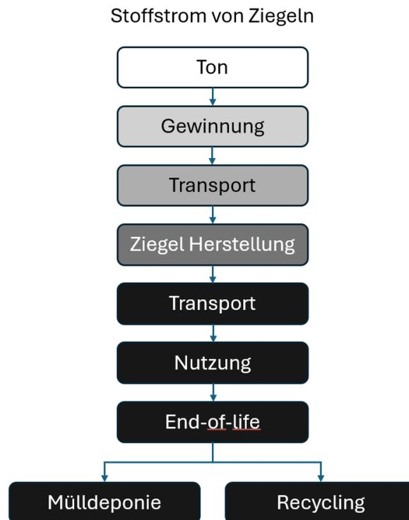
Abbildung 6: Stoffstrom von Ziegeln
