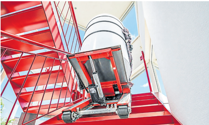
Körperlich schwere Arbeit gehört oft zum Handwerk. Wo es geht, nutzt Sachsenmaiers Team die Hebehilfe für Heizkessel.
